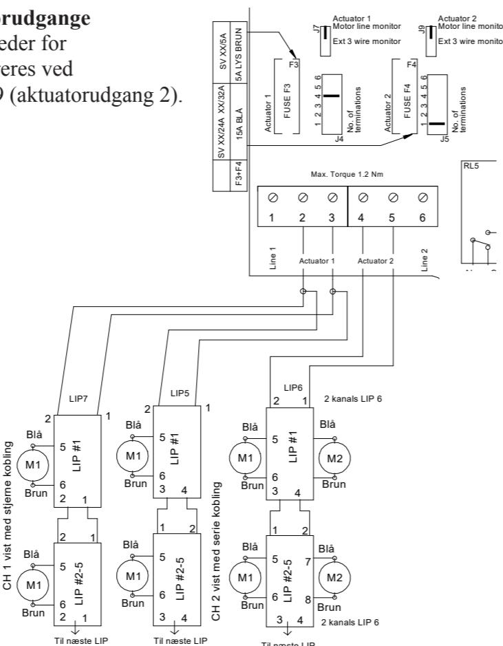
**Eksempel på linjeovervågning med 2 x jumpere (fra software version 499):**
